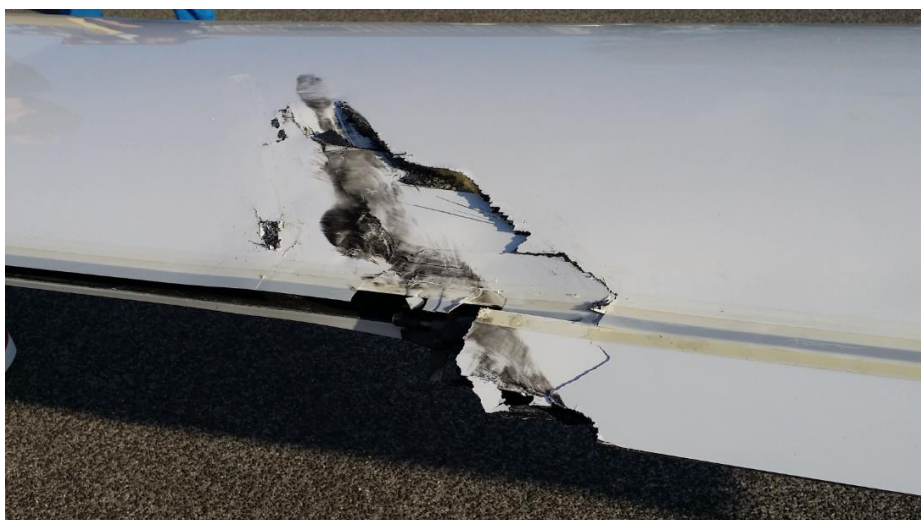
Foto 2: primo piano dei danni presenti sulla semiala destra del D-KKGT.
