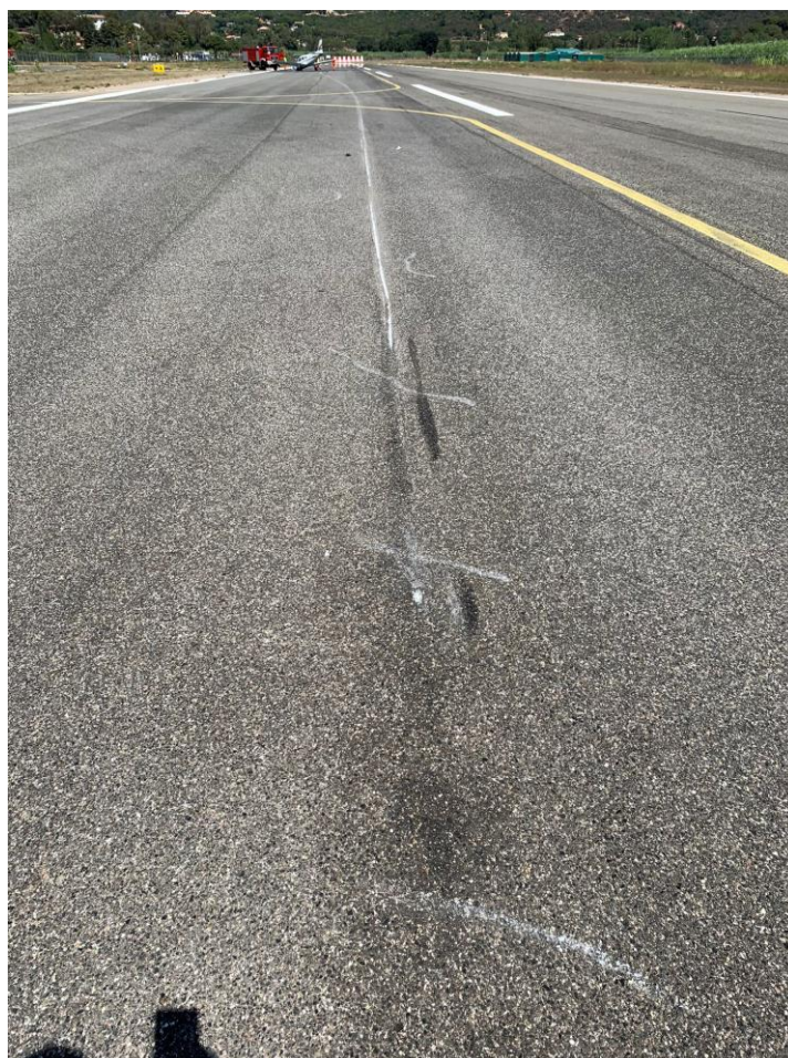
Foto 2: tracce di impatto dell'elica sulla pista e strisciata sul muso sino al punto di arresto finale.
