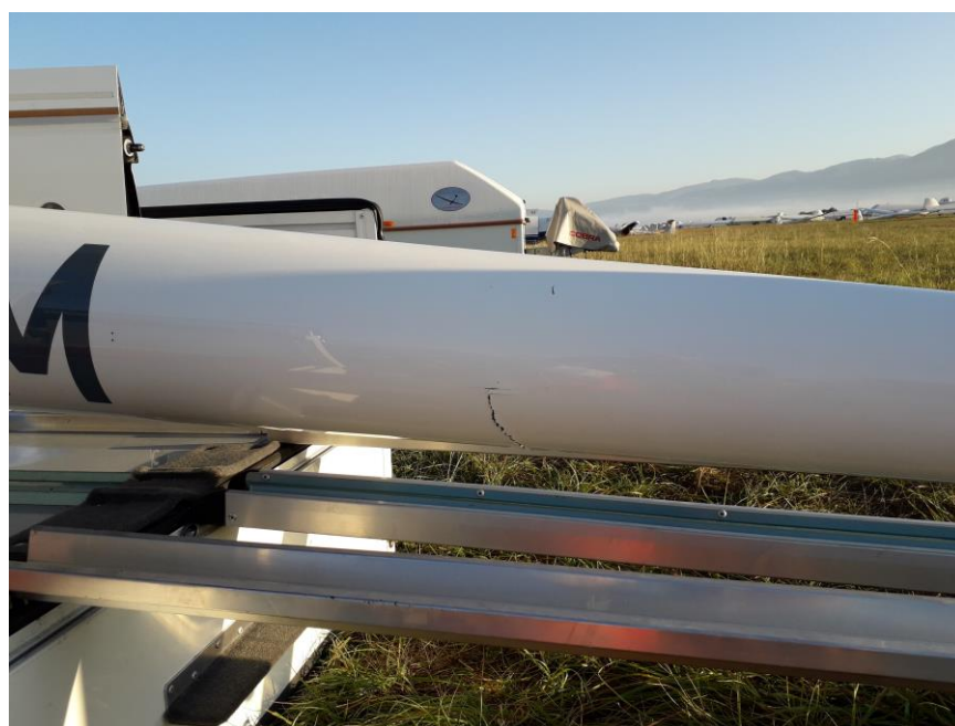
Foto 2: primo piano del danno riportato in fusoliera dal D-KGCM.
