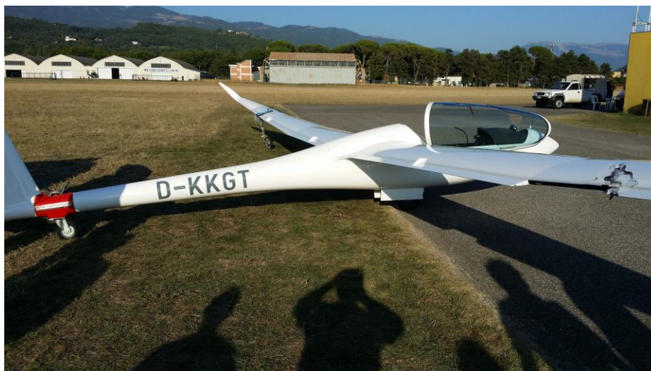
Foto 1: notare i danni sulla semiala destra e sul tettuccio riportati dal D-KKGT.
