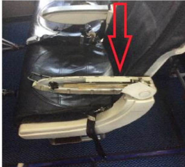
Foto 1: bracciolo del sedile danneggiato.
