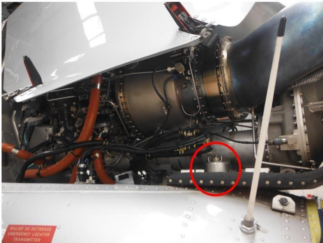
Foto 4: particolare dei danni subiti dai sostegni del vano motore.
