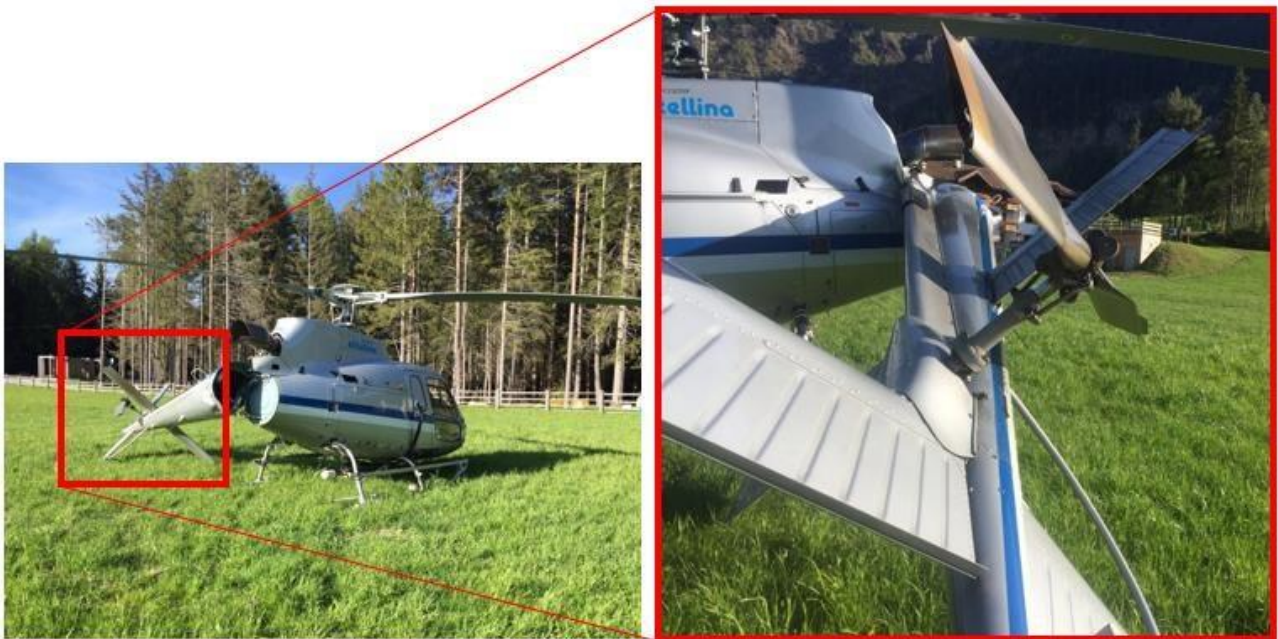
Foto 8: posizione dell'elicottero immediatamente dopo l'incidente e particolare del rotore di coda.
