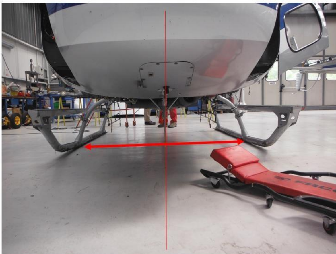
Foto 2: particolare dello svergolamento dei pattini dovuto all'urto con il terreno.
