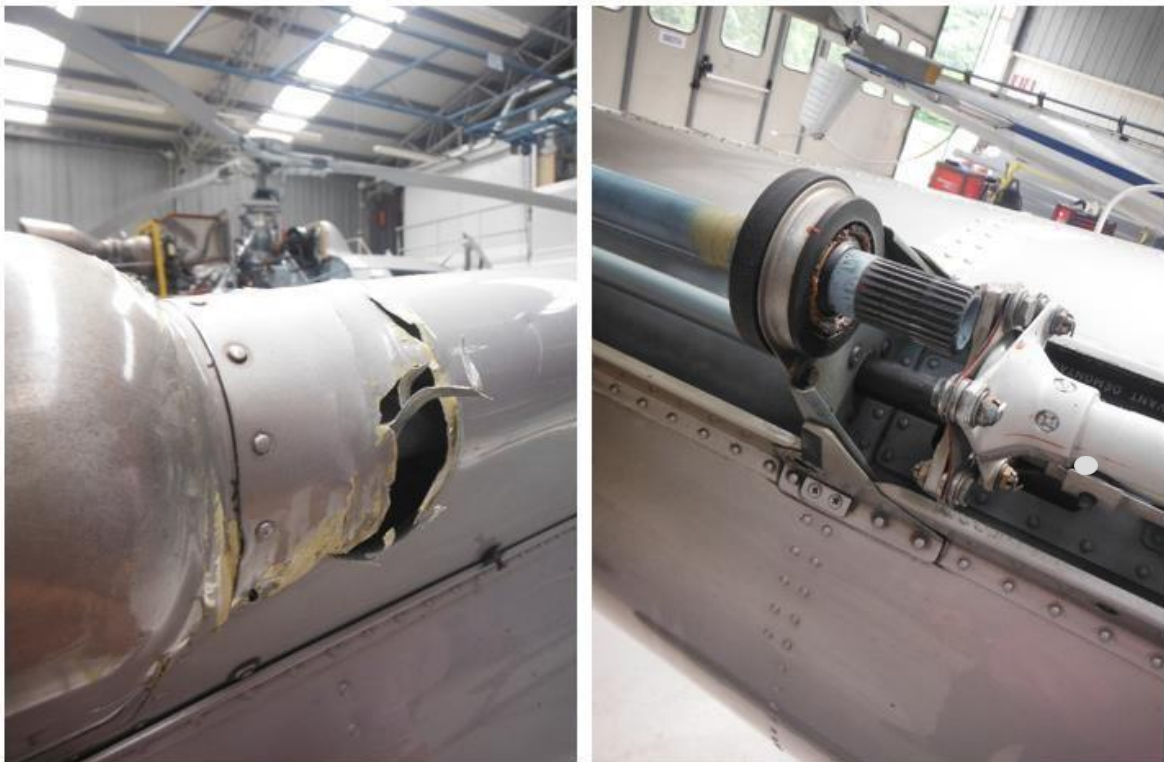
Foto 6: particolare dei danni al carter ed all'albero di trasmissione del moto al rotore di coda.
