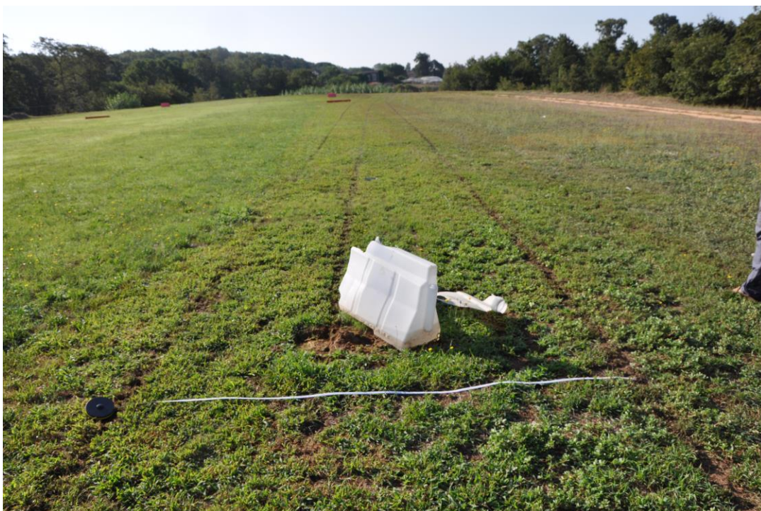
Foto 3: impronte al suolo e jersey danneggiato.
