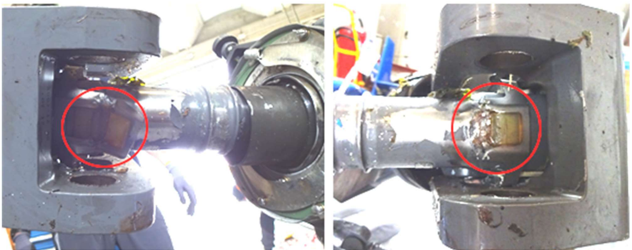
Foto 7 a sinistra e 8 a destra: particolare del mast e dei due teeter stop con i segni di mast bumping .
