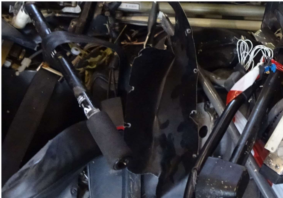
Foto 10: il comando collettivo con selettore RPM governor in posizione off .
