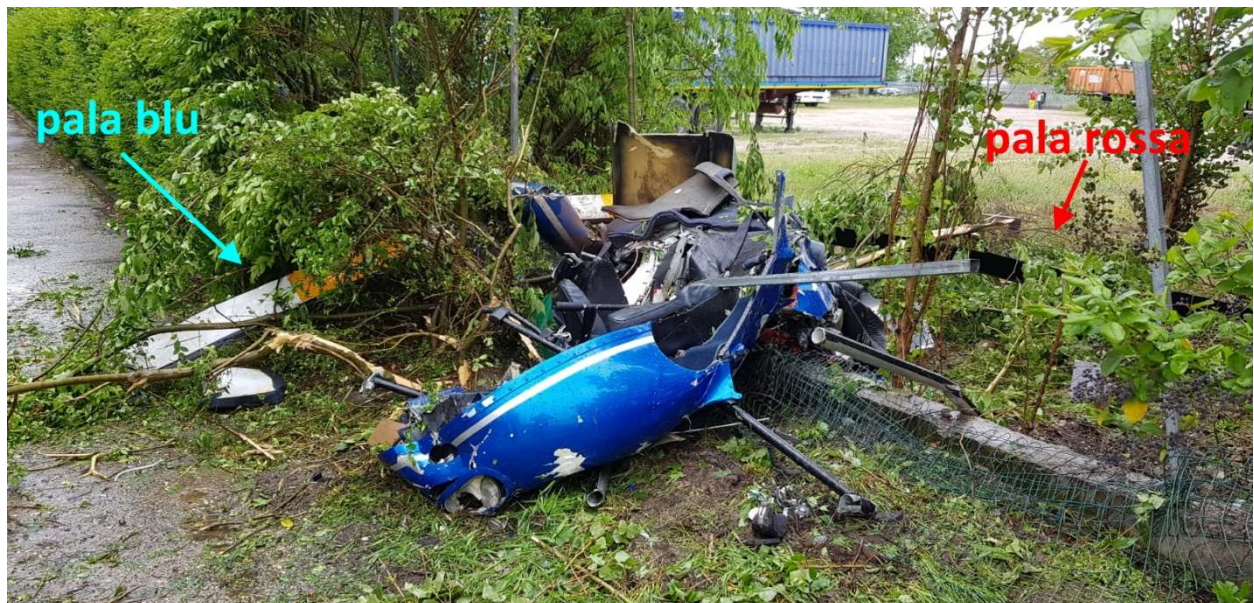
Foto 3: vista del relitto principale con indicazione della pala blu e rossa.
