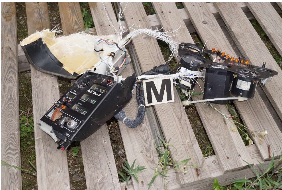
Foto 5: il pannello strumenti rinvenuto a circa 40 metri di distanza dal relitto principale.
