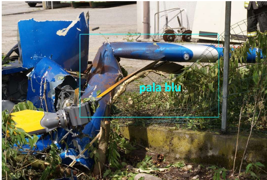
Foto 4: pala blu sotto la trave di coda spezzata.
