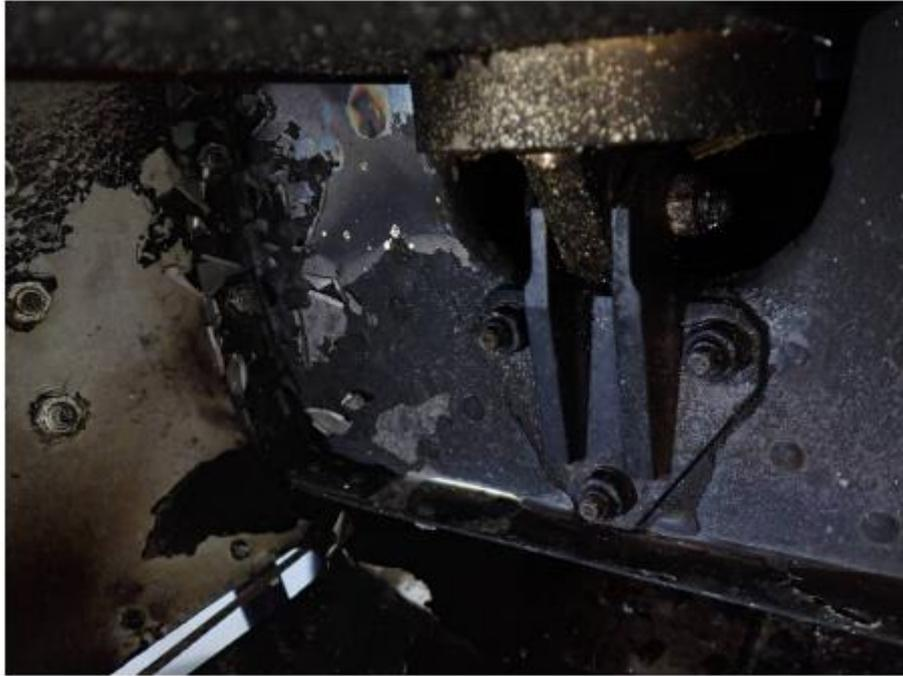
Foto 36: punto di attacco inferiore dell'attuatore alla fusoliera.
