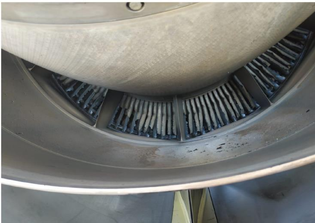
Foto 2: danneggiamenti del motore sinistro visibili dall'esterno.
