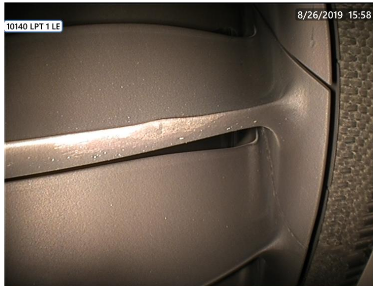
Foto 40: rilavorazione sulle palette LPT.
