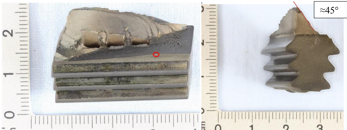
Foto 33: superficie di rottura.
