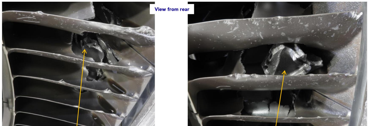
Foto 15: frammenti IPT incastrati nel gruppo statorico LPT.
