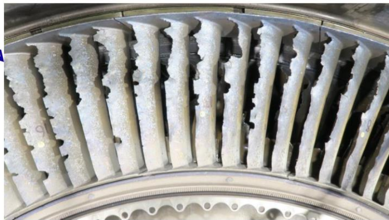
Foto 30: danneggiamento 5° stadio LPT.
