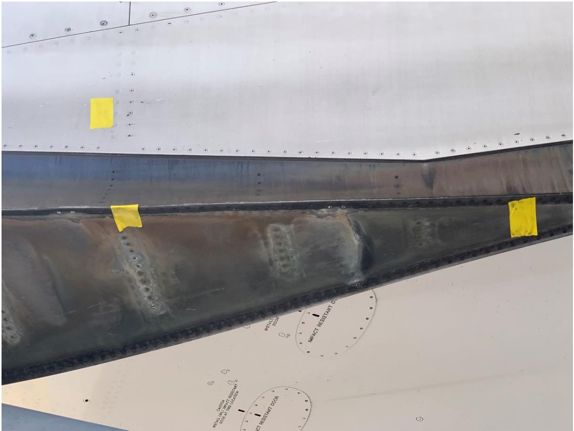
Foto 6: danneggiamenti al pylon fairing.
