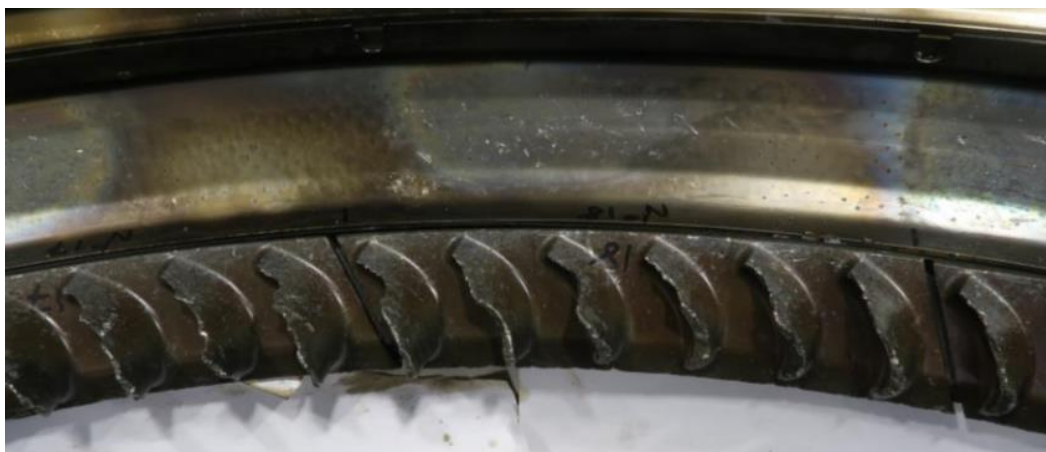
Foto 25: danneggiamento NGV 2° stadio LPT.
