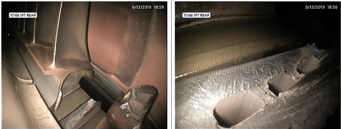
Foto 10: superficie di rottura del danneggiamento primario costituito dal distacco di una paletta IPT, che ha indotto la rottura di quella adiacente e successivamente gli ulteriori danni nel motore descritti al paragrafo 1.16.
