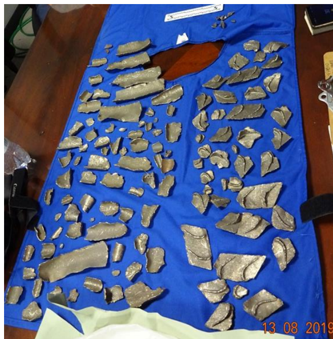
Foto 11: frammenti di palette della turbina recuperati nelle strade di Fiumicino.
