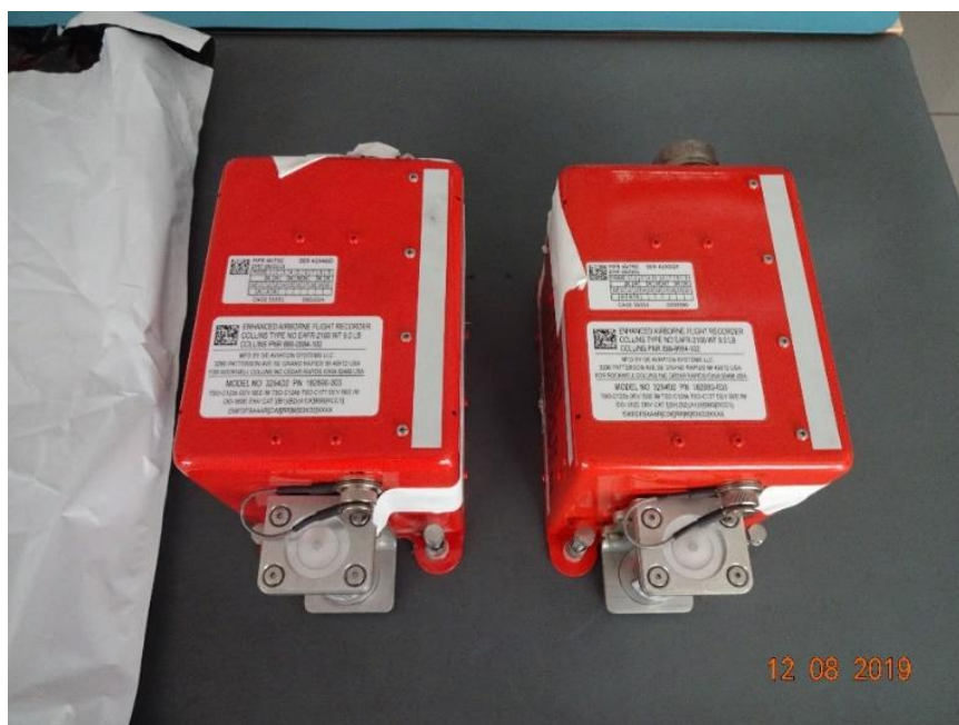
Foto 13: EAFR installati a bordo del LN-LND.
