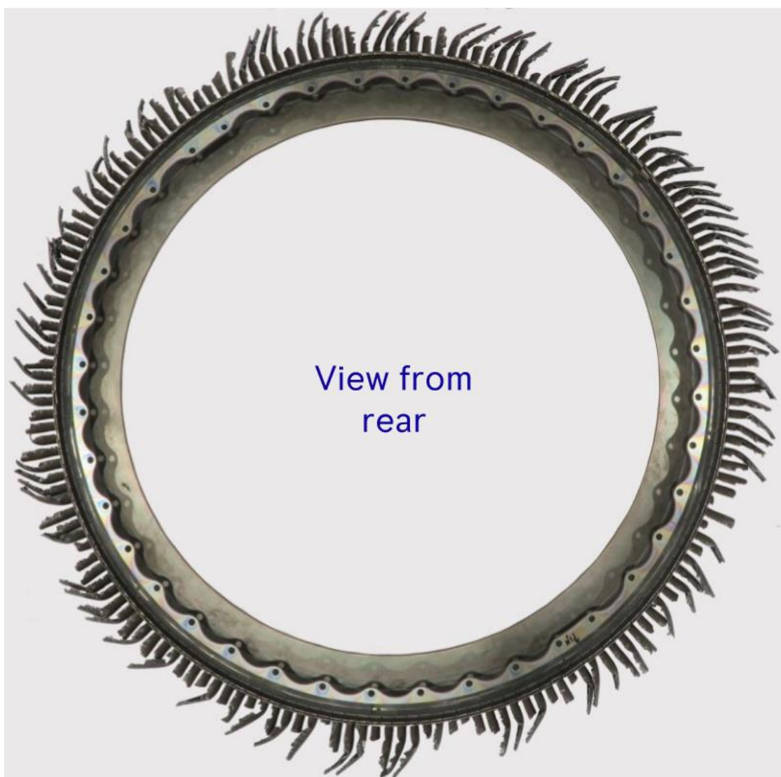
Foto 24: danneggiamento rotore 1° stadio LPT.
