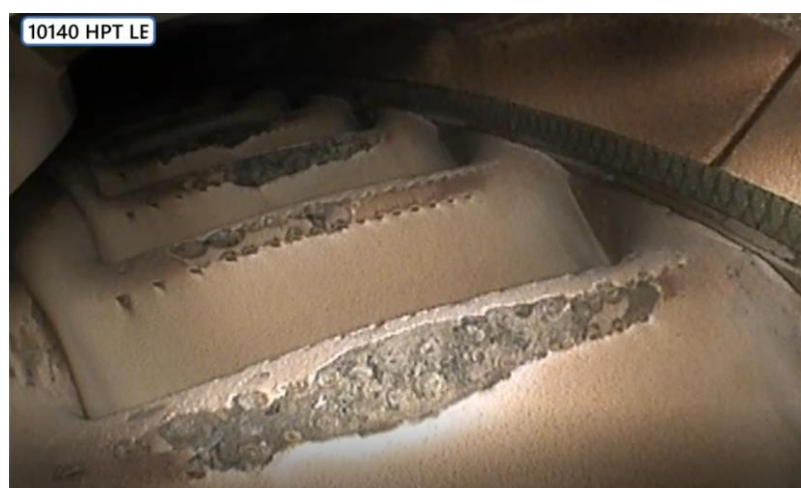
Foto 39: erosione sulle palette HPT.
